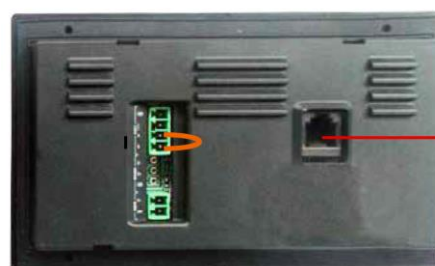
Для кабеля < 3 м Разъём RJ CAN
